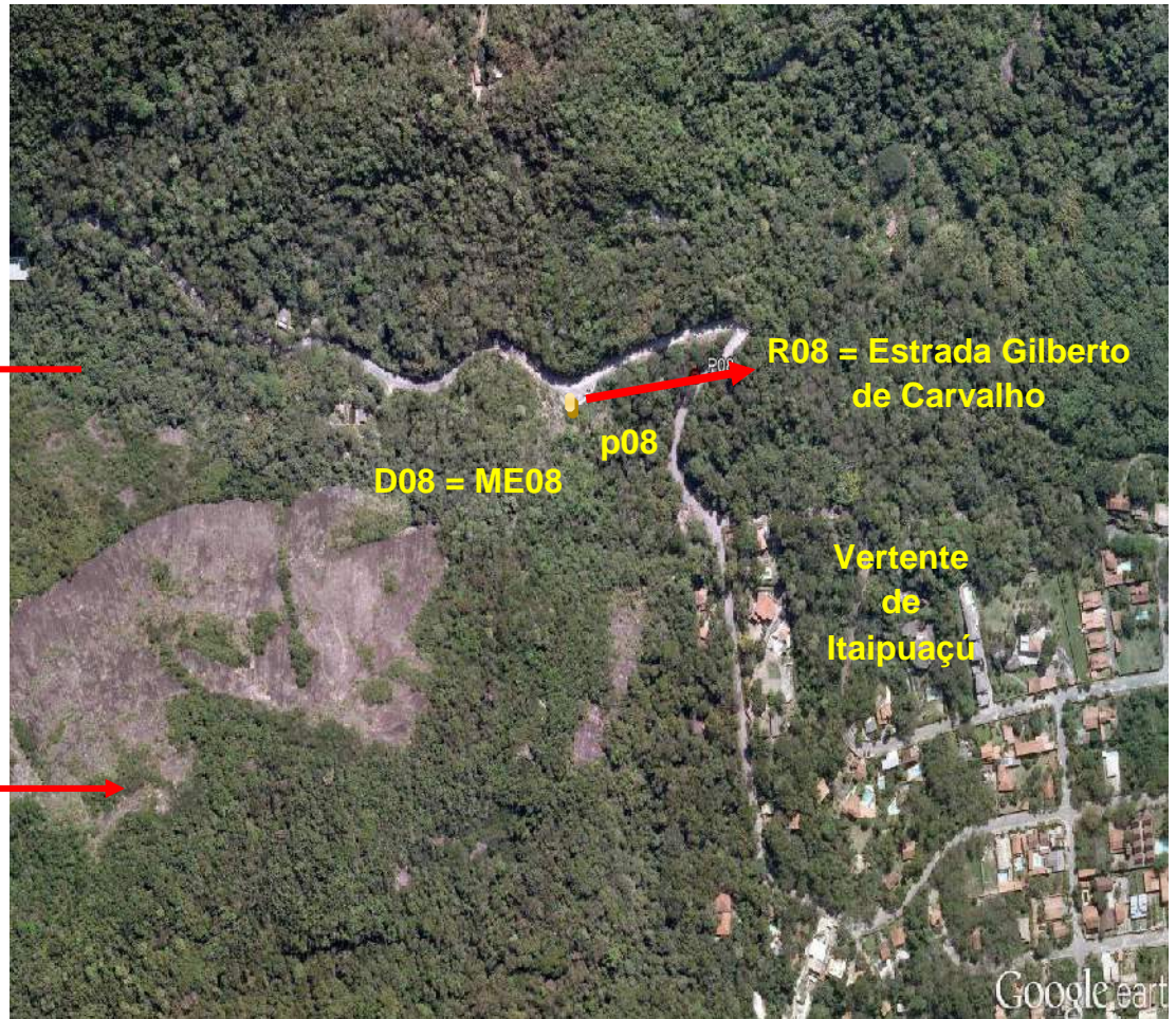
Figura 29- p08 - Ponto georeferenciado; (D08) – Encosta deslizada e em recuperação; (R08) – Estrada Gilberto de Carvalho - Área Receptora ao Movimento de Massas, (ME08) - Massa Vegetada Escorregável Fonte: Esse estudo
