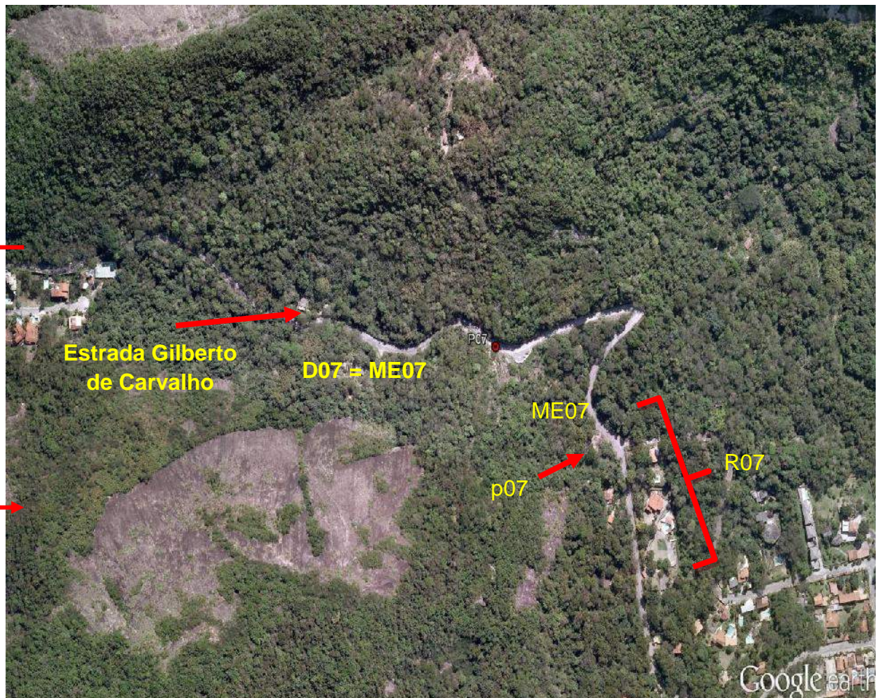
Figura 28 - p07 - Ponto georeferenciado; (D07) – Encosta deslizada e em recuperação; (R07) – Estrada Gilberto de Carvalho receptora ao Movimento de Massas; (ME07) - Massa Vegetada Escorregável, (PH) – Área de circulação automotiva e casas no talude com menor altimetria
