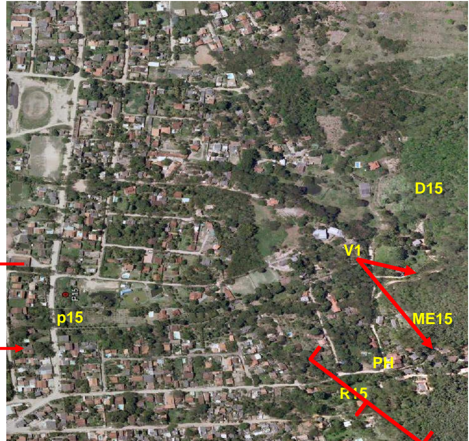
Figura 36- p15 - Ponto georeferenciado, (D15) - Encosta a ser deslizada; (R15) - Área Receptora ao escorregamento; (ME15) - Massa de Escorregamento; PH- Presença Humana e (V15) - Vias abertas em elevadas altitudes no talude Fonte: Esse estudo
