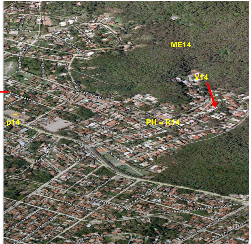
Figura 35- p14 - Ponto georeferenciado, onde: (D14) - Encosta a ser deslizada; (R14) - Área Receptora ao escorregamento; (ME14) - Massa Escorregável; PH - Presença Humana; (V14) - Vias abertas no sopé Fonte: Esse estudo
