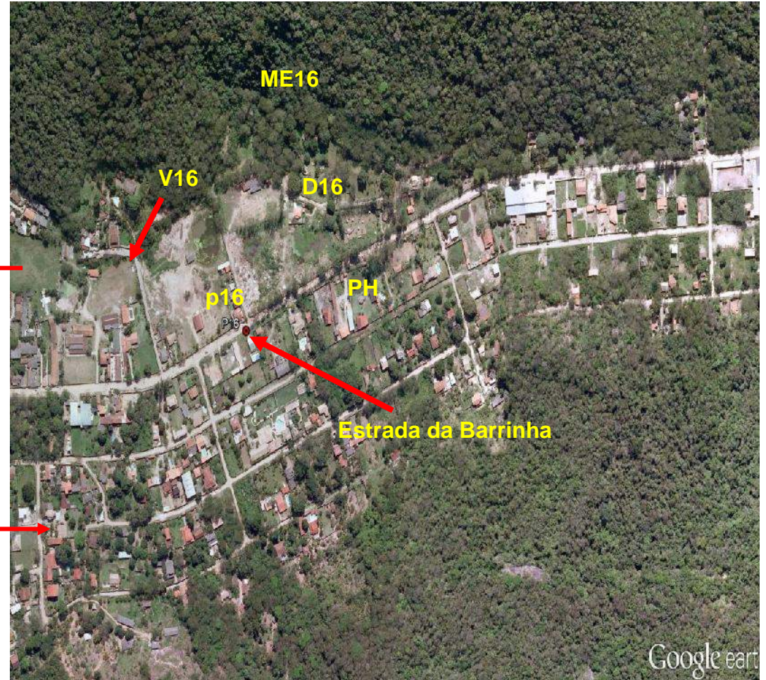
Figura 37- p16 - Ponto georeferenciado, onde: (D16) - Encosta a ser deslizada; (R16) - Área Receptora ao escorregamento; (ME16) = Massa Escorregável; PH - Presença Humana e; (V16) - Vias abertas sobre casas Fonte: Esse estudo
