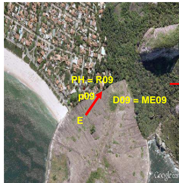
Figura 30 - p09 - Ponto georeferenciado, onde: (D09) - Encosta a ser Deslizada; (R09) - Área Receptora ao Movimento de Massa na Rua das Papoulhas; (ME09) - Massa Vegetada Escorregável, (PH) - Presença Humana, (E) - Nenhum espaço entre talude e casa construída Fonte: Esse estudo
