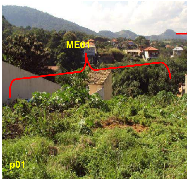
Figura 22 p01 - Ponto georeferenciado; (D01) - Encosta a ser deslizada; (V01) - Via automotiva aberta sobre casas; (R01) - Área Receptora ao deslizamento; (PH) - Presença Humana; (R01) - área Receptora ao escorregamento e; (ME) - Massa Escorregável.
