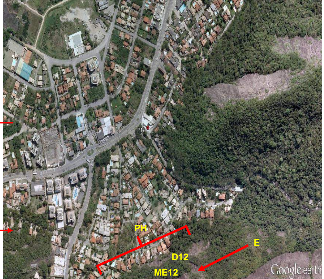
Figura 33 - p12 - Ponto georeferenciado, onde: (D12) - Encosta a ser deslizada; (R12) - Área Receptora ao escorregamento; (ME12) = Massa Escorregável vegetada; PH - Presença Humana; (E) - Fratura rochosa Fonte: Esse estudo
