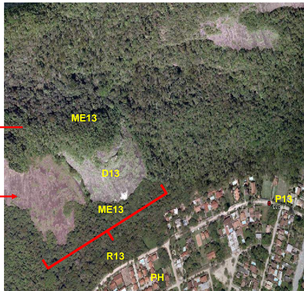
Figura 34 - p13 - Ponto georeferenciado, onde: (D13) - Encosta a ser deslizada; (R13) - Área Receptora ao escorregamento; (ME13) - Massa de escorregamento e; (PH) - Baixa Presença Humana. Fonte: Esse estudo.
